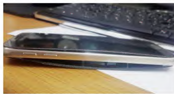
삼성전자 갤럭시S6 모델 중 배터리 부풀음 현상이 발생한 제품.
